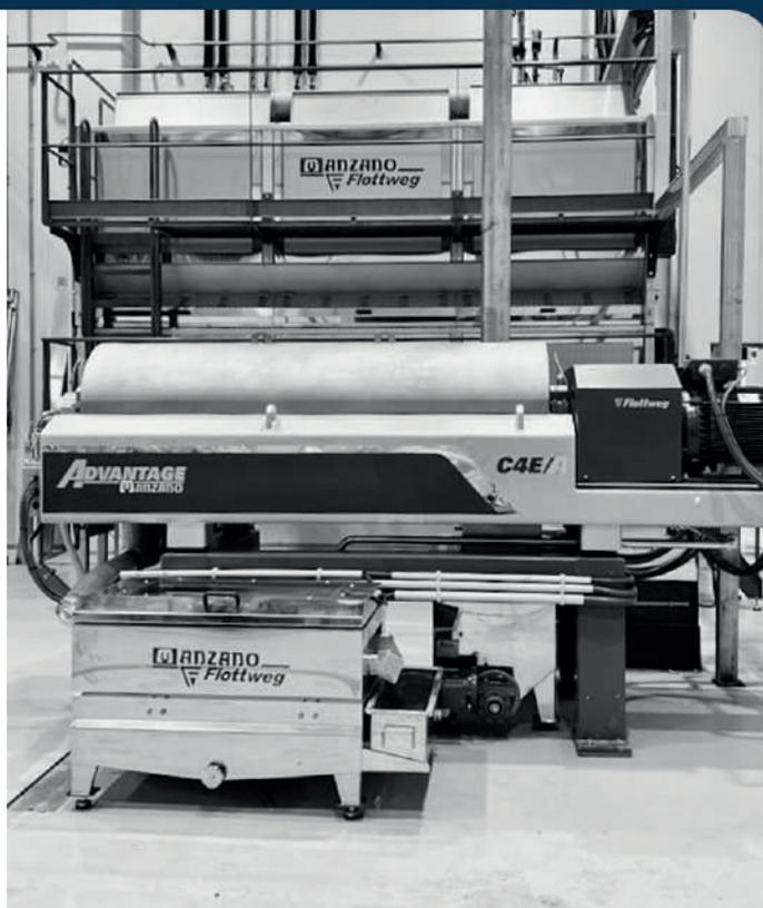
A **série Z** conta com a projeção tecnologicamente mais avançada do mercado. Inovações técnicas como o SIMP DRIVE® que facilita a regulação automática da velocidade diferencial do sem fim em função da carga, e detalhes técnicos que facilitam a sua manutenção e operação durante a sua longa vida útil. Uma série para separação em duas ou três fases em função da necessidade de cada cliente.
