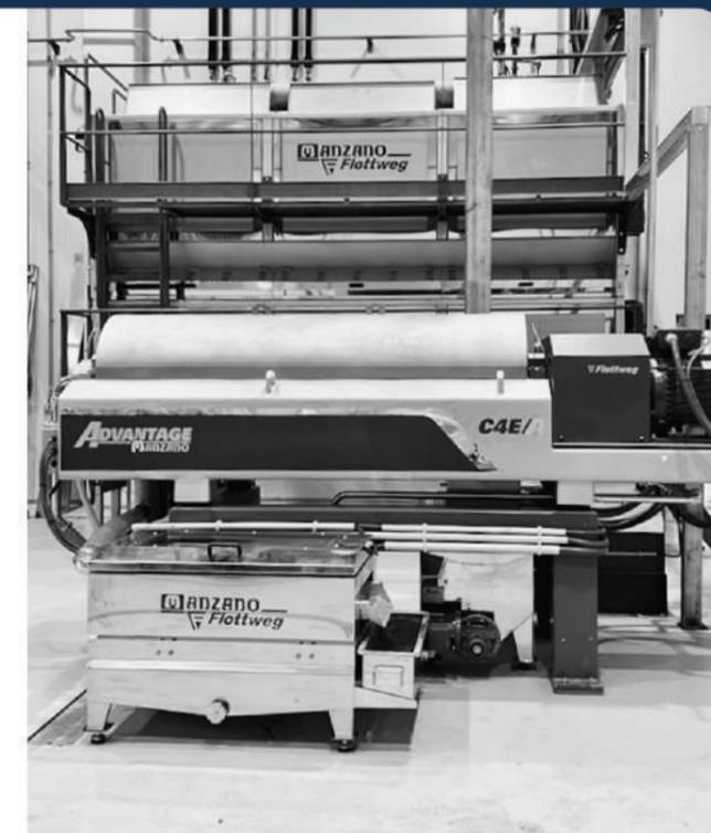
La serie Z cuenta con el diseño tecnológicamente más avanzado del mercado. Innovaciones técnicas como el SIMP-DRIVE® que facilita una regulación automática de la velocidad diferencial del sinfín en función de la carga, y detalles técnicos que facilitan su mantenimiento y operación durante su larga vida útil. Una serie para separación en dos o tres fases en función de la necesidad de cada cliente.
