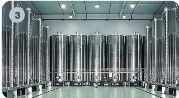
Depósitos fabricados íntegramente en acero inoxidable y diseñados específicamente para el almacenamiento de aceite de oliva.
